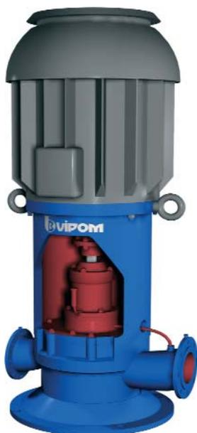
Центробежный одноступенчатый вертикальный судовый насос типа К предназначен для перекачивания пресной и морской воды, или других жидкостей, близких по вязкости, удельному весу и химической активности к воде с температурой до 85°C.
