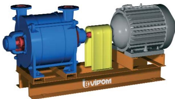
Вакуумный ротационный насос типа ВП предназначен для откачивания воздуха из корпуса и всасывающего трубопровода насоса до их пуска в действие, а также для получения и поддержки определенного разряжения в различных аппаратах и установках. Применяется для откачивания невоспламеняемых, химически нейтральных, чистых от механических примесей газов и газожидкостных смесей. Приводом насоса служат трехфазные асинхронные электродвигатели.
