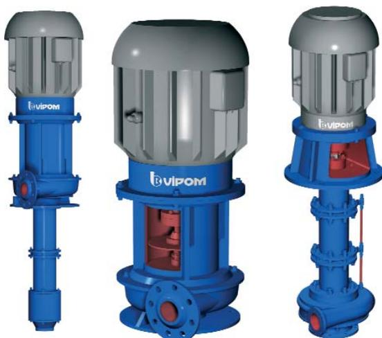
Вертикальные сдвоенные насосы типа ВС предназначены для перекачивания чистой и слабозагрязненной водохранилищной, речной, грунтовой воды, с температурой до 40°C и с максимальным размером частиц до 0,5 мм при концентрации 1000 мг/л.
