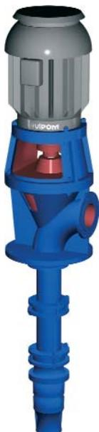
Артезианские насосы типа А предназначены для скважинных колодцев. Насосы этого типа могут перекачивать воду с температурой до 80°C, чистую или с содержанием сухих веществ без абразивных материалов до 50 гр/л.
