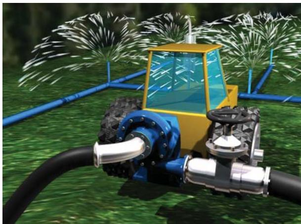
Насосная приставка МПП использует привод от любого трактора. Предназначена для работы в сельском хозяйстве для полива и осушения открытых каналов, рек и других водоемов. Может быть использована для дождевых установок, капельного полива и полива путем естественного водотока. Также применяются для перекачивания воды из одного водоема в другой.
