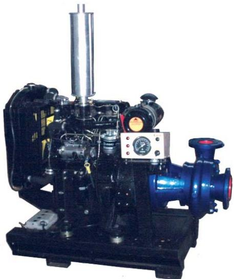
Центробежные горизонтальные одноступенчатые самовсасывающие насосы типа Д и Е с двигателем внутреннего сгорания предназначены для перекачивания чистой воды и других жидкостей без механических примесей, имеющих сходные с водой свойства по вязкости и химическому составу, температурой до 80°C. Удобны при использовании в сельском хозяйстве для полива, осушения или других нужд, кроме энергоснабжения.
